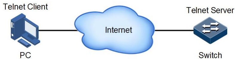
图1-6 通过 Telnet 方式远程登录设备组网示意图
