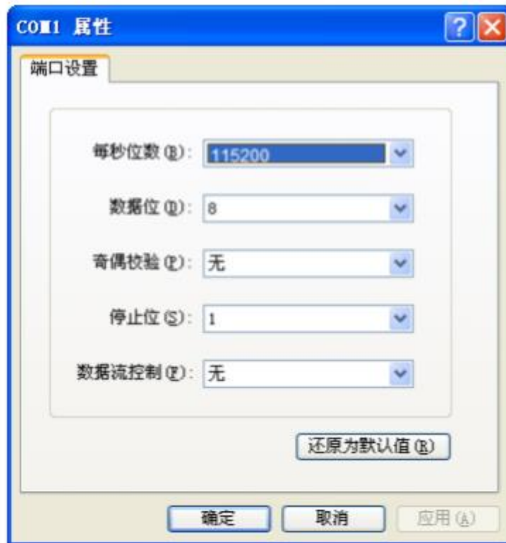
图1-2 “超级终端”中的通信参数配置示意图
